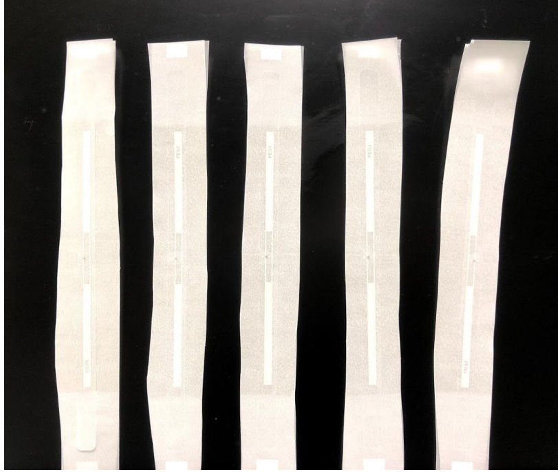
ภาพ 46 Passive Tag ที่ใช้กับคลื่นวิทยุแบบ UHF
