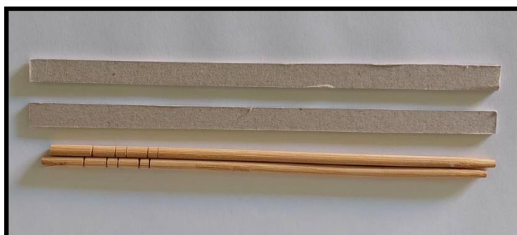
ภาพที่ 14 อุปกรณ์ตั้งระยะร่องบานพับปกแข็ง
